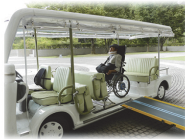
車いすに乗ったまま利用できる 施設内移動用乗用カート
